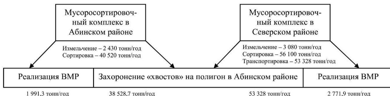
Мощность мусоросортировочного комплекса в Абинском районе позволяет сортировать до 50 000 тонн/год и в Северском до 60 000 тонн/год.
